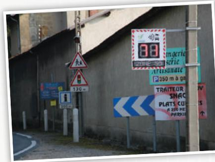
Un radar pédagogique vient d'être installé à l'entrée sud du village, des réglages ont été effectués pour sa mise en fonctionnement. Il affiche la vitesse, en vert si l'utilisateur est en dessous de la limite, en rouge au-delà jusqu'à un seuil maximum généralement de 20 km/h au-dessus de la limite. Il informe les conducteurs de leur vitesse sans les sanctionner, afin de les inciter à adapter leur comportement.
